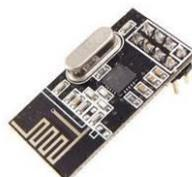
低工作電壓：1.9 ~3.6V 低電壓工作(2)高速率：2Mbps，由於空中傳輸時間很短，極大的降低了無線傳輸中中的碰撞現象。(3)多頻點：125 頻點，滿足多點通信和跳頻通信需要。(4) 小型：內置 2.4GHz 天線，體積小巧，15x 29 mm。
